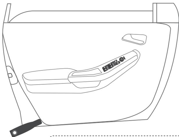
Com uma espátula fina, retire a tampa dos parafusos. Em seguida retire os parafusos para retirar o forro da porta e iniciar a instalação.
